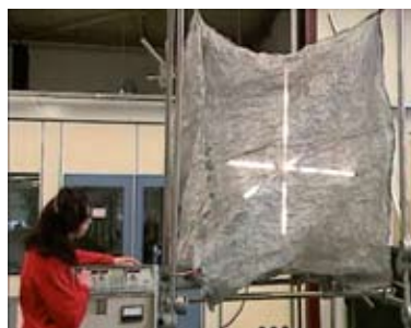
Figuur 4. Drie fluorescentiebuisen in de VIRC, bij een geïnjecteerd vermogen van 50 W.
