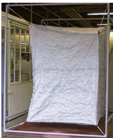
Figuur 3. De VIRC: een flexibele tent van geleidend materiaal, met verplaatsbare wanden.
